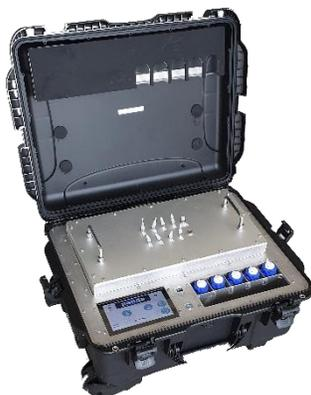
Le PANDa, grâce à sa technique de Voltamétrie par stripping anodique (Squarewave voltametry), est capable de détecter l'arsenic total dans les eaux usées, industrielles et potables avec une limite de détection très sensible (L.O.D de  $1 \mu\text{g/L}$ ).
